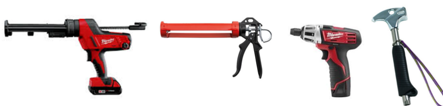
Aplicadores de químicos, atornillador eléctrico para introducir varillas roscadas a alta velocidad y romper ampollas químicas (fundamental para garantizar el mezclado), y martillo para AMM.
