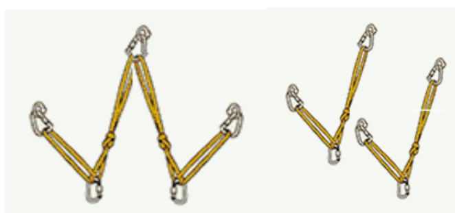
Fig.: dos tendidos de cuerdas para acceso, uno para cada operario. En el de la izquierda, el SAS de la cuerda de trabajo y el de la cuerda de seguridad comparten un anclaje, situación aceptable con anclajes de alta resistencia únicamente. En el de la derecha, el operario posee una cuerda de trabajo con dos anclajes independientes a los dos anclajes de su cuerda de seguridad.
